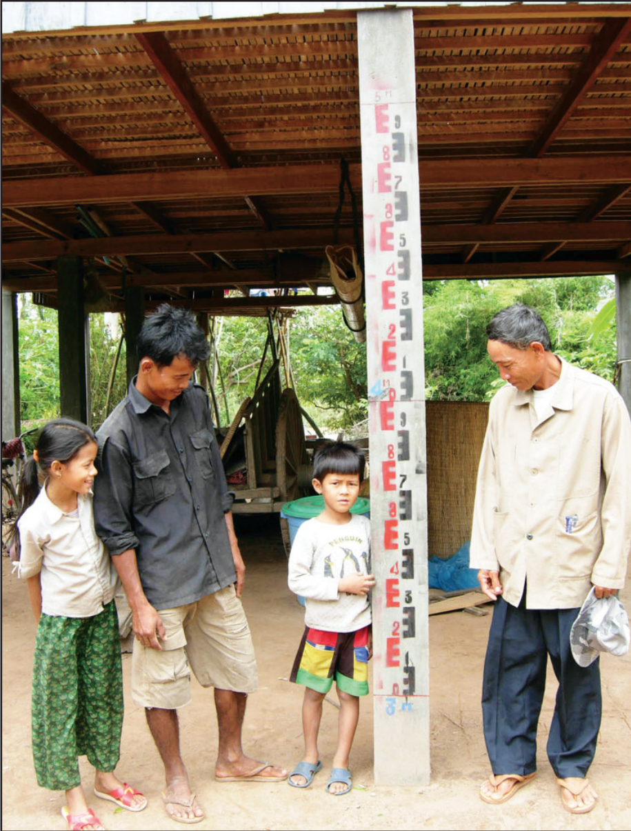
បង្គោលម៉ែត្រស្ទង់ទឹកដាក់នៅតាមផ្ទះរបស់អ្នកភូមិគឺជាឧបករណ៍ដ៏មានប្រសិទ្ធភាពក្នុងការផ្តល់ព័ត៌មានកំពស់ទឹកជំនន់ទៅកាន់ប្រជាជន។ មិនមែនប្រជាជនទាំងអស់ទេ ដែលមានលទ្ធភាពទទួលបានព័ត៌មានពីការព្យាបាលទឹកជំនន់ ឬក៏បង្គោលម៉ែត្រស្ទង់ទឹក ដែលដាក់នៅក្រៅភូមិរបស់គេ។
